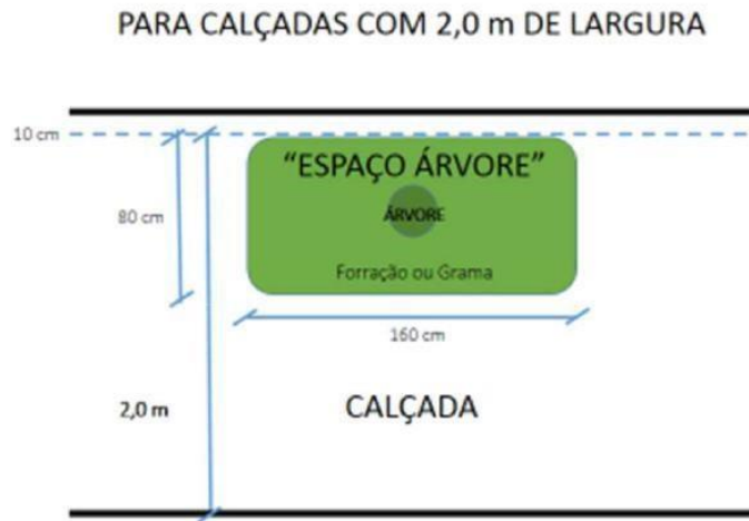
Figura 3: Medidas para calçadas de 2,0m
