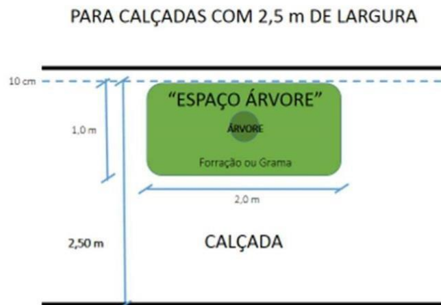
Figura 2: Medidas para calçadas de 2,5m
